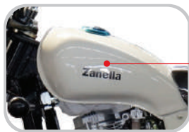
Tanque de combustible
