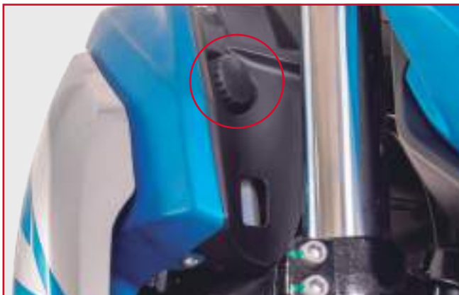
TANQUE DE EXPANSIÓN DE LÍQUIDO REFRIGERANTE.
