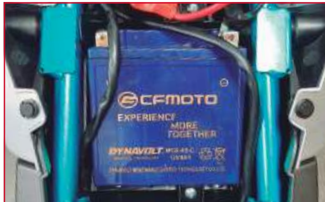
LA BATERÍA SE ENCUENTRA BAJO EL ASIENTO DEL CONDUCTOR.
