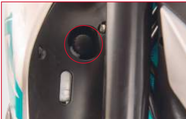
TANQUE DE EXPANSIÓN DE LÍQUIDO REFRIGERANTE.
