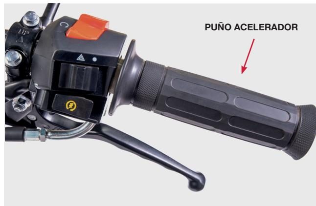
1. Chequee la suave rotación del puño del acelerador desde la posición totalmente abierta a totalmente cerrada.
