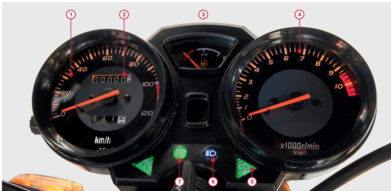
1. Velocímetro 2. Odómetro o Cuenta kilómetros 3. Indicador de posición de marcha 4. Tacómetro 5. Indicador de luz de giro.
