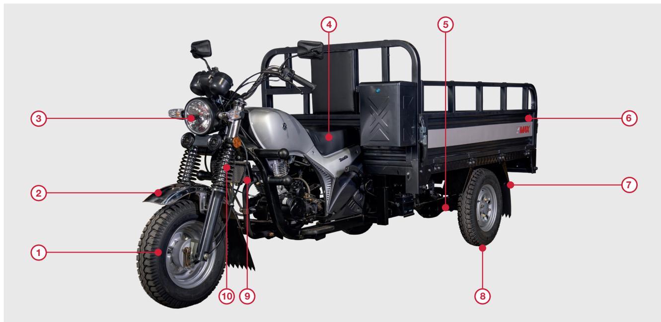
1. Rueda delantera 2. Guardabarro delantero 3- Farol delantero 4- Asiento 5- Elástico 6- Caja de carga 7- Guardabarro trasero
