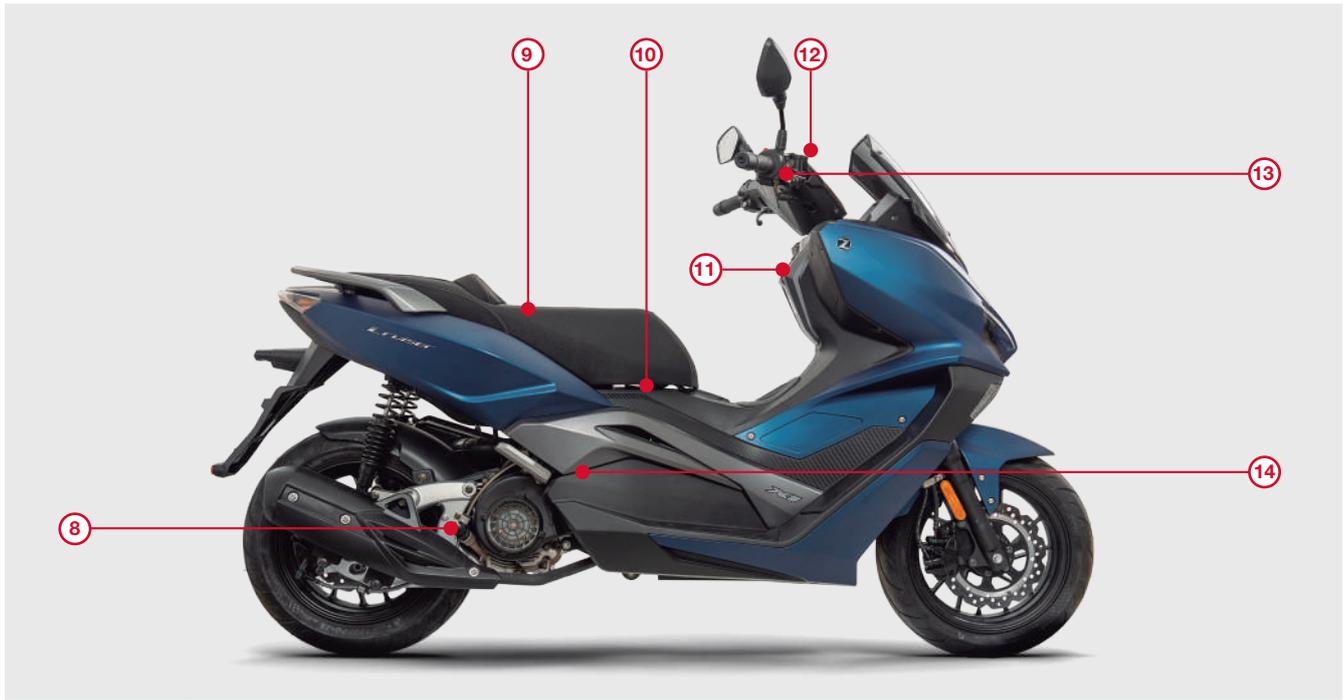
**8.** Tapa del filtro de aceite del motor **9.** Baúl con kit de herramientas **10.** Compartimiento de la batería y los fusibles
