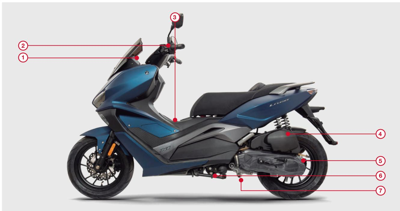
1. Panel de instrumentos   2. Palanca de freno trasero   3. Tapa del tanque   4. Filtro de aire   5. Tapón de llenado de aceite de transmisión   6. Muleta   7. Caballete principal
