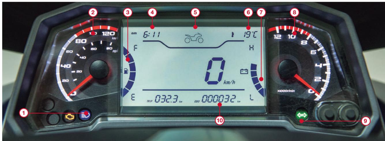
Cada vez que se enciende el scooter, se inicializará automáticamente la autoinspección y se encenderán todas las luces, el puntero se mueve y se posiciona en el cero. Si el puntero no se mueve, acérquese a un concesionario para que realicen una revisión.
